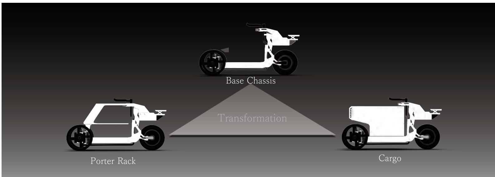
NOHAKO はユーザーと共に創るモビリティ。BaseChassis を用いてユーザーの要望に合わせて積載する「HAKO」を作製する。移動だけでなく箱を変えることで移動販売や、キャンプ・災害時の物資 / 人員輸送、配達など様々なシーンでの活用が見込める。また NOHAKO は一部部品にジェネレーティブデザイン（AI）を活用している。必要項目に数値を入力することで条件達成に見合う造形を自動生成する。本展示では造形部品を金属 3D プリンターで出力している。パウダーベッド方式の造形で細かいアルミの粉をレーザーで焼結し、造形を行っている。
